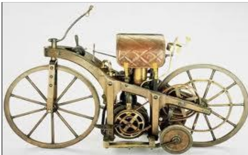
Slika 1. Gottlieb Daimler izradio je 1885. prvi motocikl pogonjen benzinskim motorom
