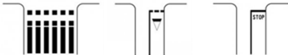
Slika 9: Primjeri poprečnih oznaka na kolniku
