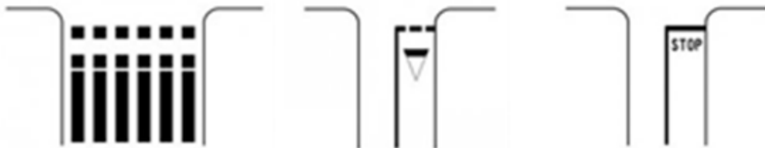
Slika 9: Primjeri poprečnih oznaka na kolniku
