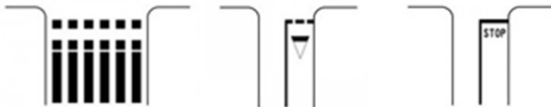
Slika 9: Primjeri poprečnih oznaka na kolniku
