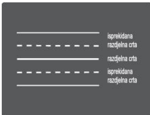
Slika 11: Primjer razdjelne i isprekidane razdjelne crte
