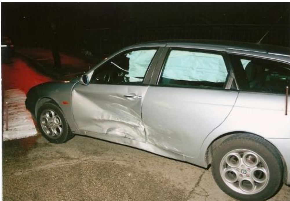
Slika 1. Oštećenje osobnog automobila nastala u sudaru s drugim vozilom
