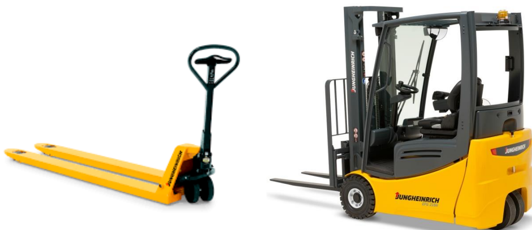
Slika 18. Ručni i električni viličar s pokretnim vilicama
