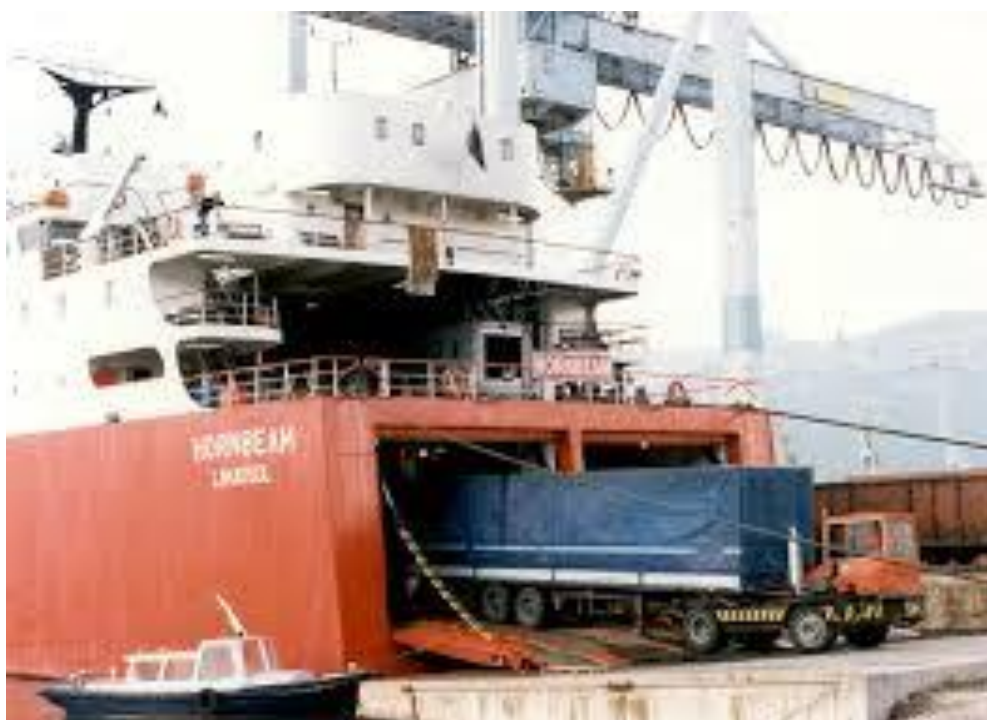
Slika 14. Način iskrcaja iz RO-RO broda
