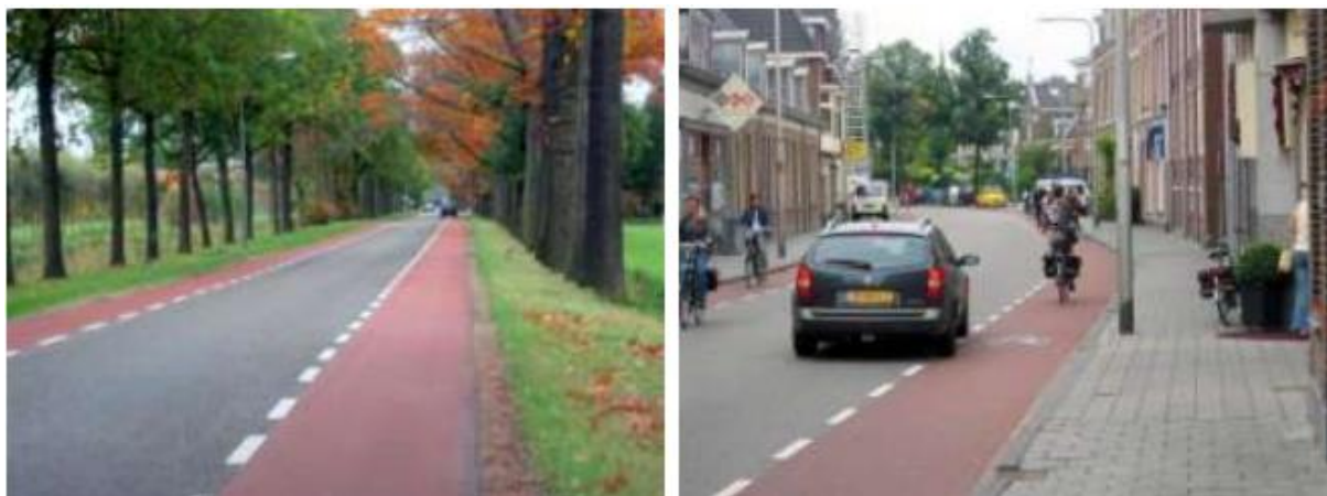
Slika 12. Biciklistička traka izvan i unutar naselja
