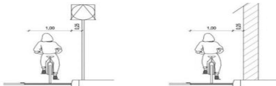
Slika 10. Širina zaštitnog pojasa uz stalne zapreke
