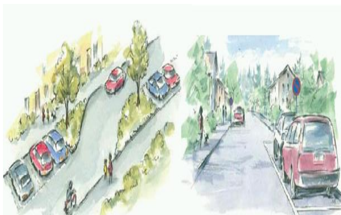
Slika 8. Izbjegavanje vođenja osi ceste u pravcu
