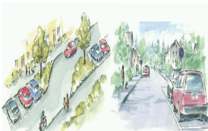
Slika 8. Izbjegavanje vođenja osi ceste u pravcu
