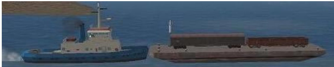
Slika 22. Prijevoz željezničkih vagona sredstvima riječnog transporta
