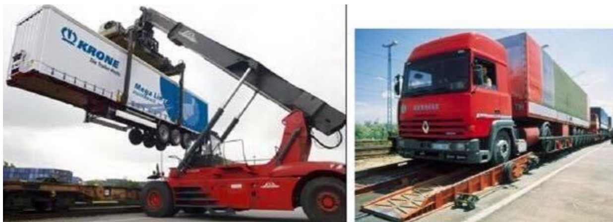
Slika 17. Huckepack tehnologija- ukrcaj cestovnih vozila na željezničke vagon
