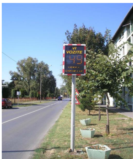
Slika 16. Smirivanje prometa uređajem za određivanje brzine vožnje
