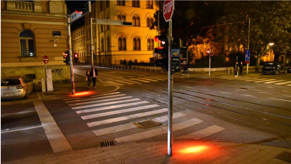
Slika 16. Primjer projiciranja svjetlosne signalizacije na pločnik
