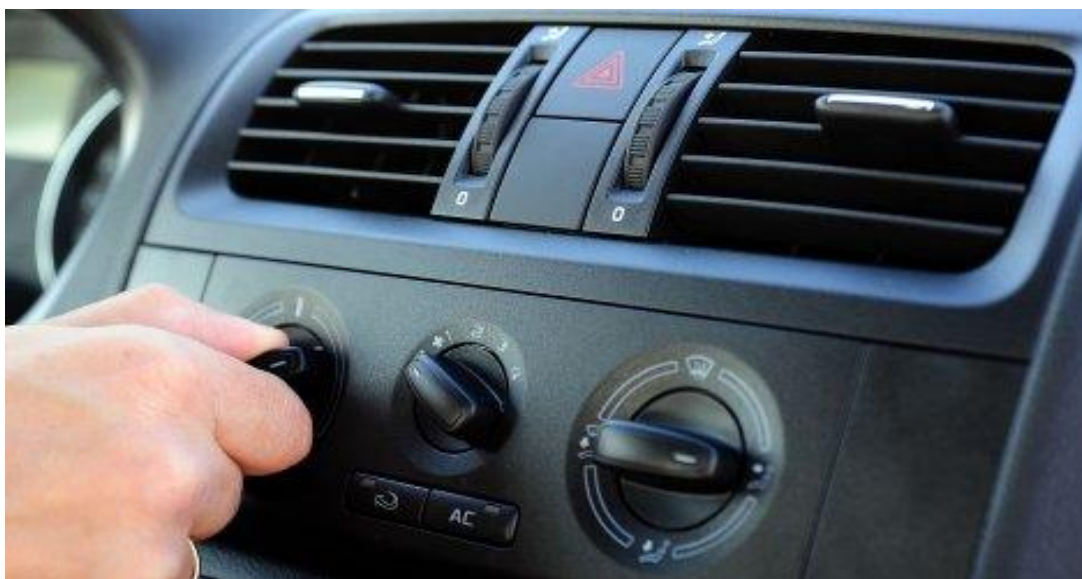
Slika 6. Uređaji za grijanje, hlađenje i provjetravanje
