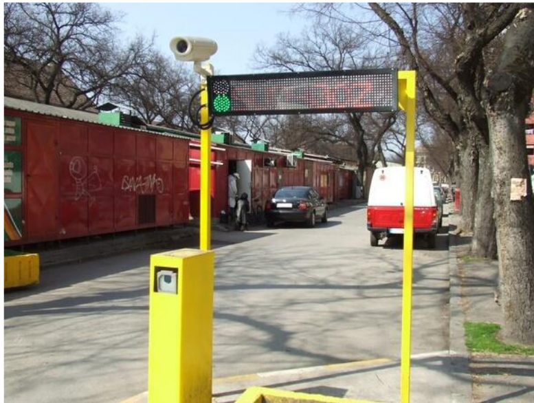
Slika 1. Sustav detektiranja oznaka na vozilu
