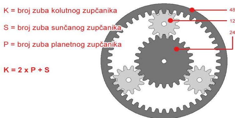
Slika 6.5. Shematski prikaz elektropokretačevog planetarija
