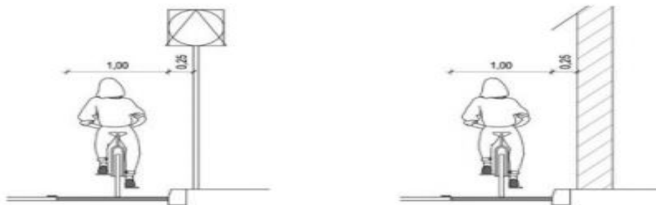
Slika 10. Širina zaštitnog pojasa uz stalne zapreke
