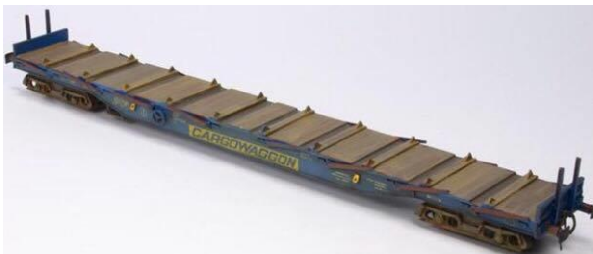
Slika 16. Plato vagon za prijevoz kontejnera
