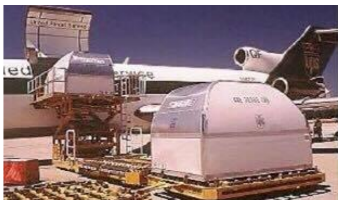
Slika 19. Različite tehnike ukrcanja kontejnera u teretne avione
