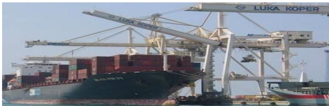
Slika 9. Pomični prekrajni kontejnerski mostovi luke Koper
