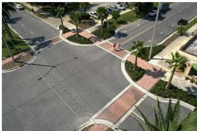
Slika 13. Primjer suženja vozne i proširenja pješačke površine
