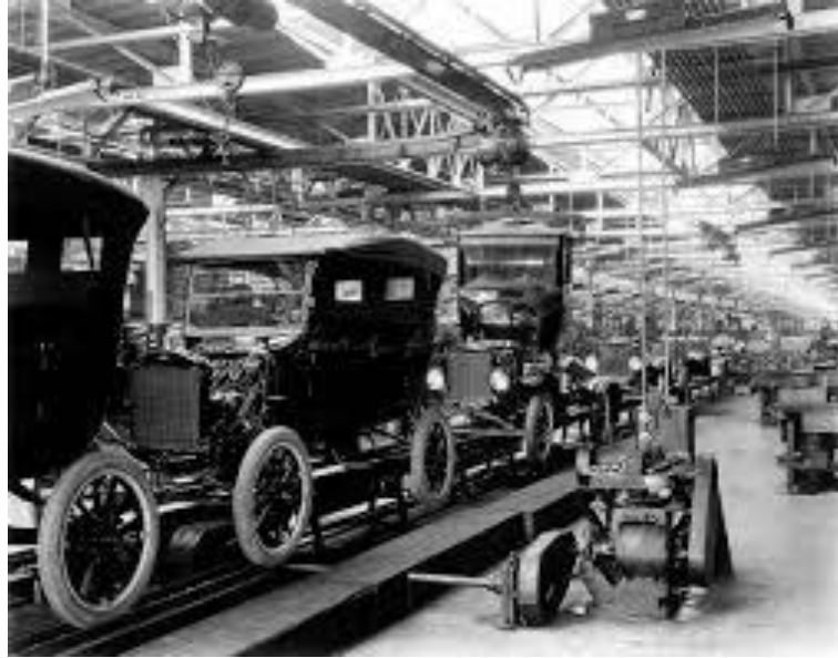
Slika 3. Pokretna traka za proizvodnju Fordovih automobila godine 1914.
