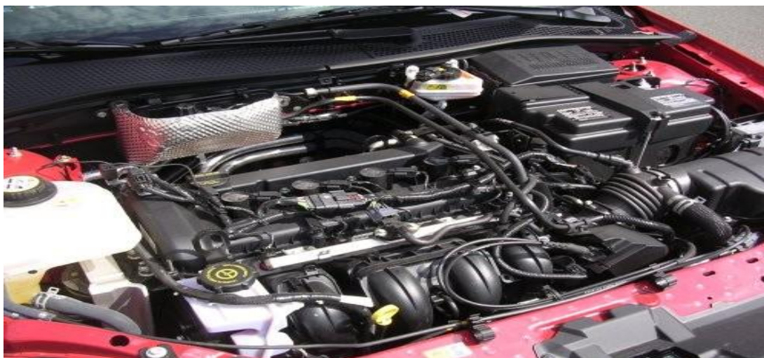
Slika 12. Položaj motora, spremnika i akumulatora
