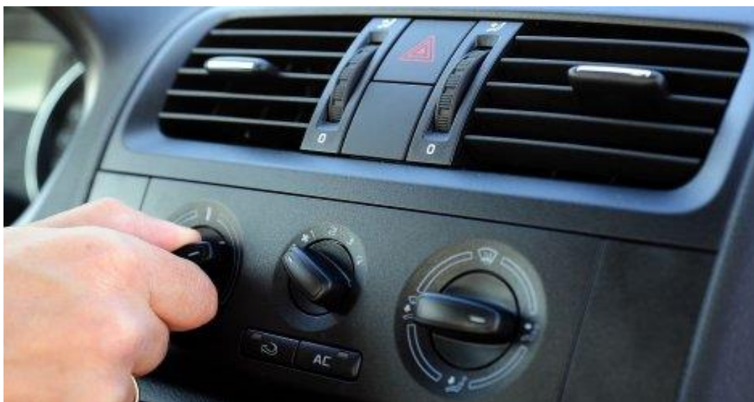
Slika 6. Uređaji za grijanje, hlađenje i provjetravanje
