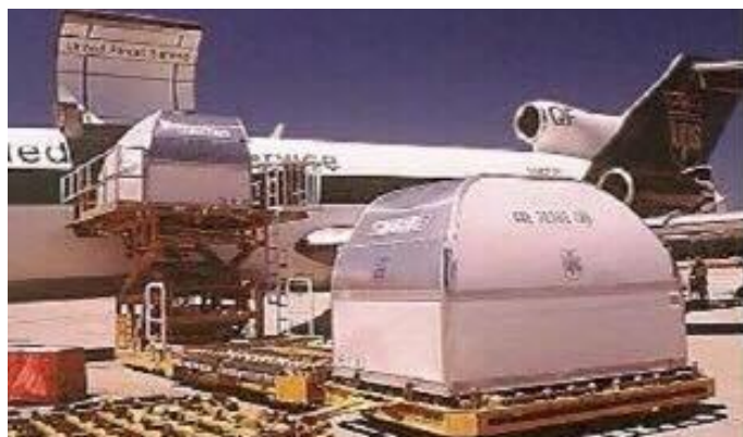
Slika 19. Različite tehnike ukrcanja kontejnera u teretne avione
