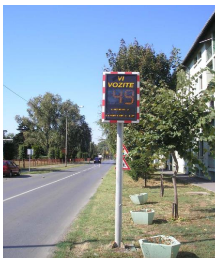
Slika 16. Smirivanje prometa uređajem za određivanje brzine vožnje
